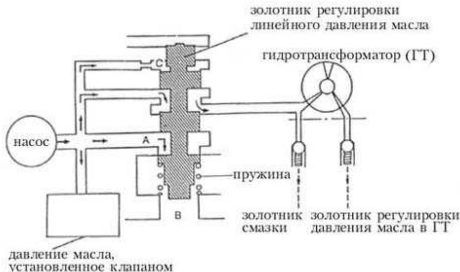
рис. 19. Клапан регулировки линейного давления масла.
