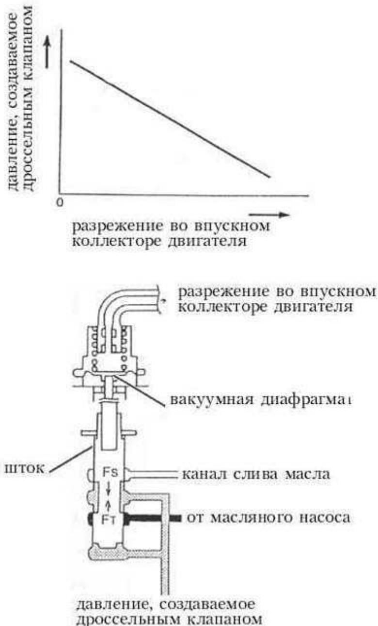
Рис. 20. Вакуумная диафрагма.
