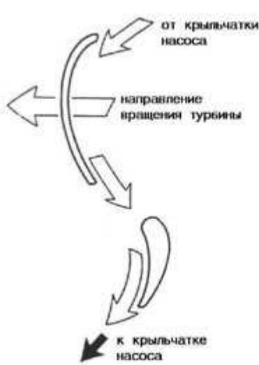
Рис. 4. Статор ГТ удерживается обгонной муфтой Рис. 5. Статор ГТ вращается свободно
