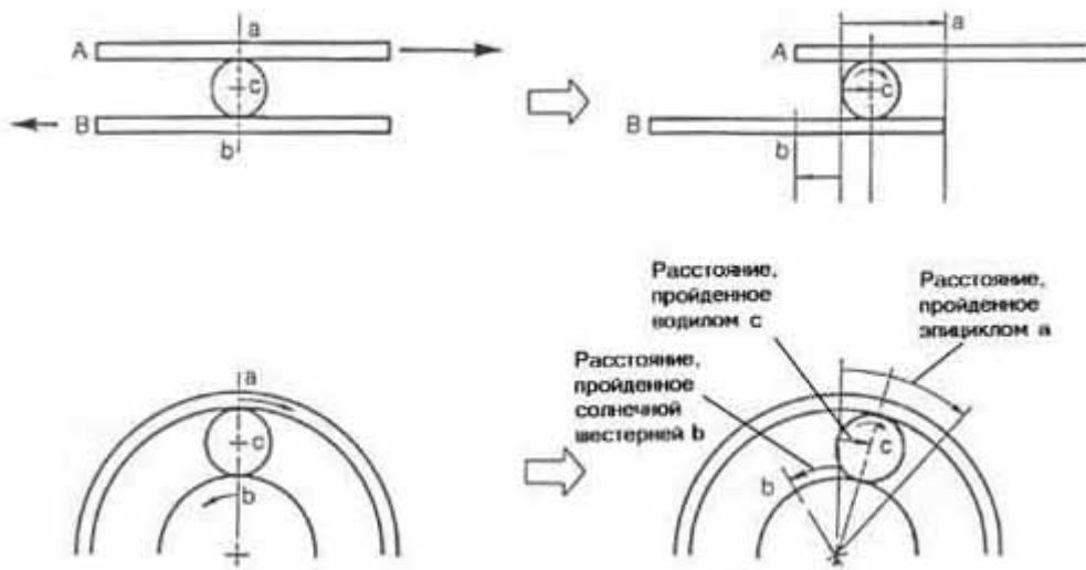
Рис. 9. Принцип 1-й или пониженной передачи в АКП
