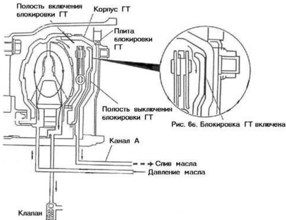
Существуют и другие способы блокировки ГТ, однако, суть всех способов одна - исключить проскальзывание турбины относительно насоса. В зарубежных источниках такой режим работы ГТ называется Lock - up (лок - ап).
