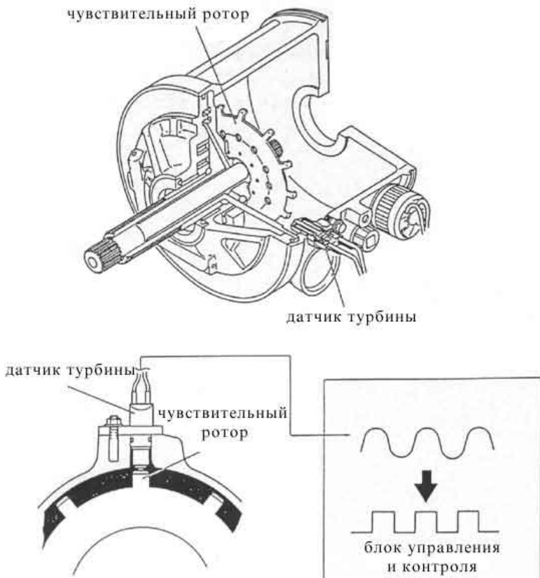
Рис. 37. Импульсный генератор.
