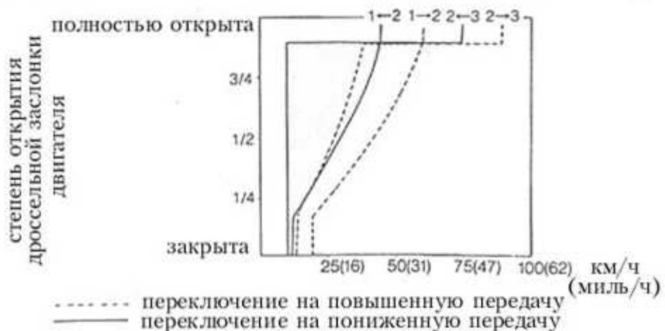
Рис. 29. Принцип действия клапана переключения передач.
