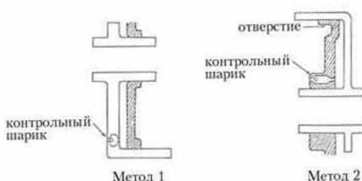
**Рис. 15. Методы устранения подвключения выключенного фрикциона.**
