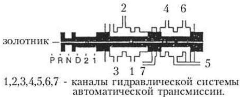
Рис. 24. Ручной клапан.
