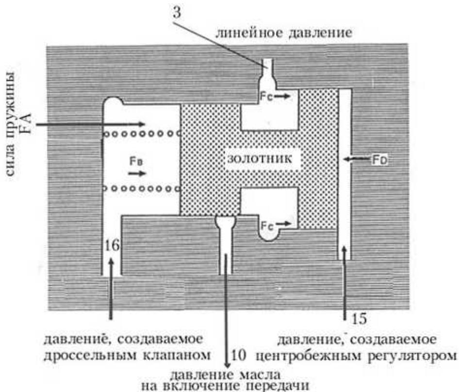
3, 10, 15, 16 - каналы гидравлической системы (см. рис. 26-28).
