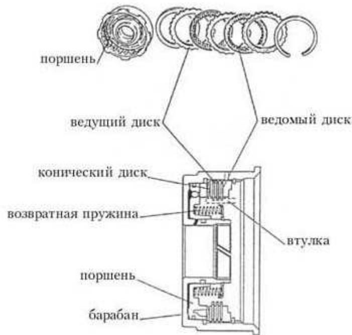
Рис. 14. Составные части фрикциона.
