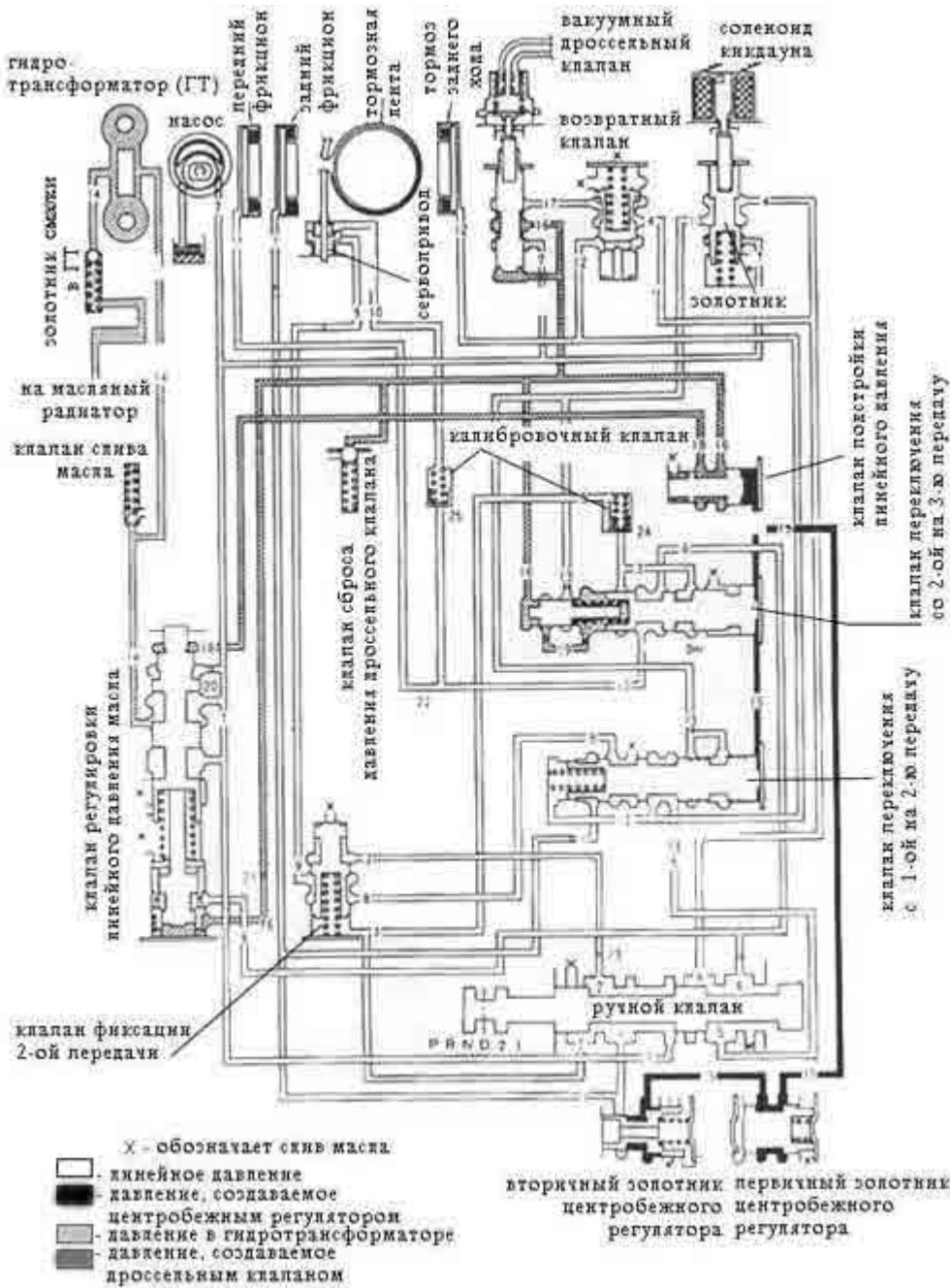
Рис. 28. Работа гидравлической системы автоматической трансмиссии при включении 3-й передачи.
