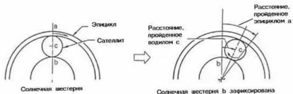
Рис. 8. Принцип 2-й передачи в АКП
