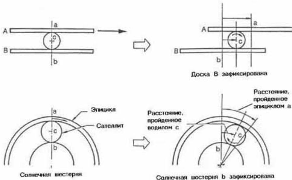
Рис. 12. Принцип 4-й передачи в АКП
