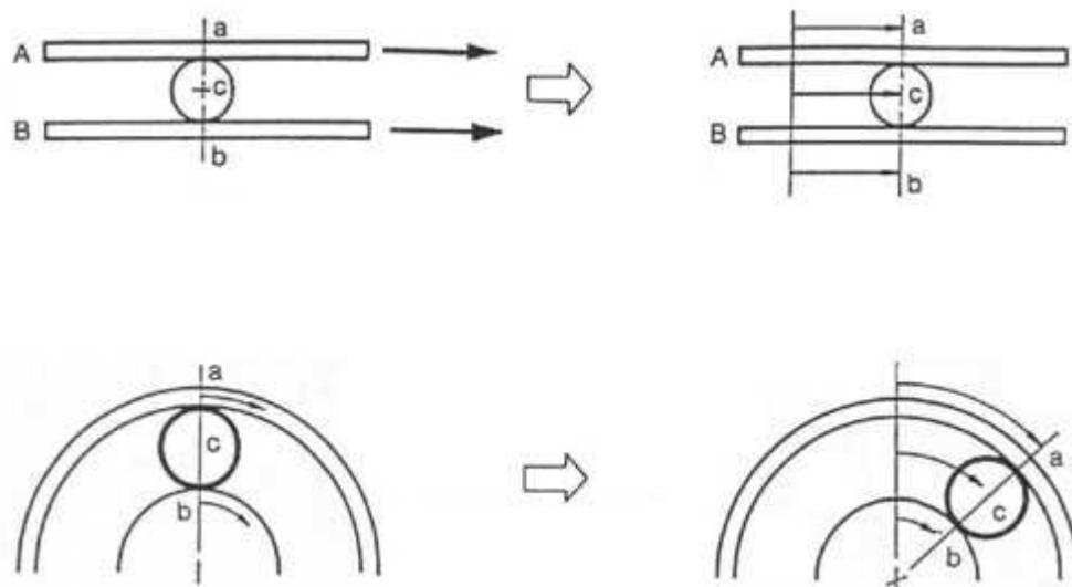
Рис. 10. Принцип 3-й передачи в АКП
