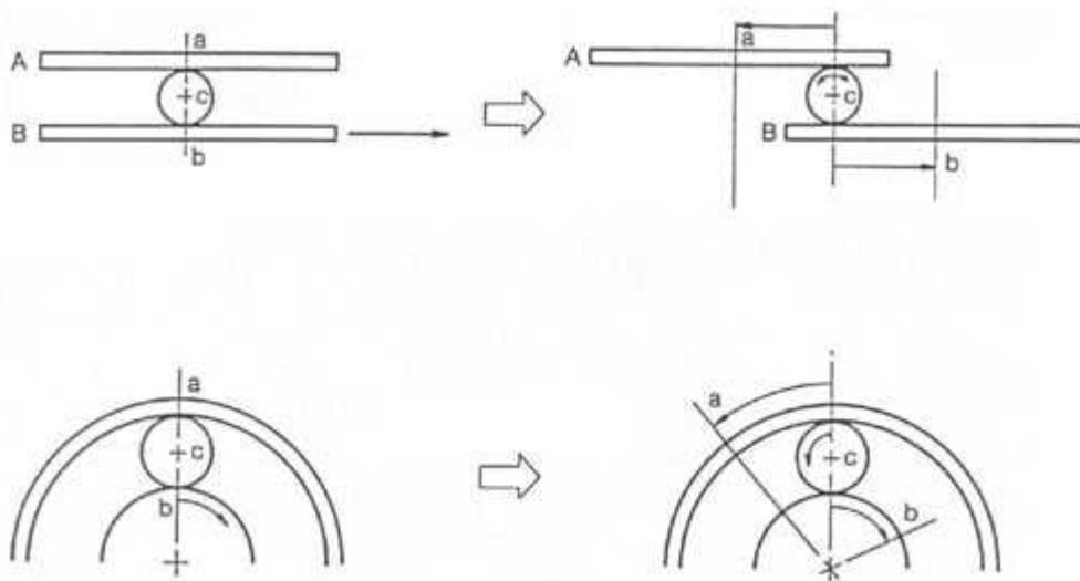
Рис. 11. Принцип задней передачи в АКП
