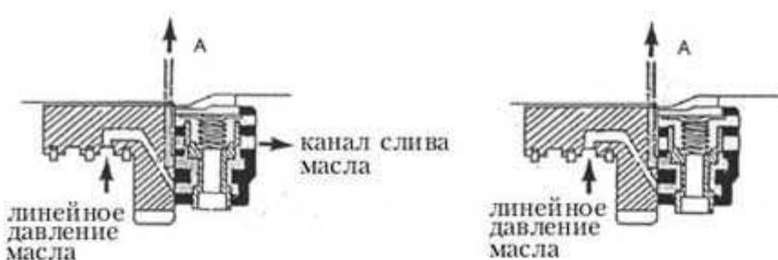
Рис. 22. Центробежный регулятор типа А.
